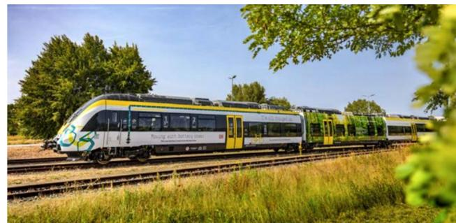
Als Fahrzeug ist der Oberleitungs-Hybrid-Triebwagen Talent 3 in Diskussion. Er fährt auf der Hauptbahn unter Fahrdrabt und lädt dabei seine Batterien. Auf Nebenstrecken kann er bis zu 100 km weit ohne Oberleitung fahren.
